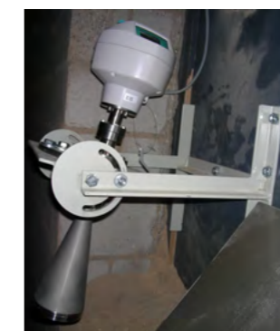
Silo-Füllstandmessung mit Radar
